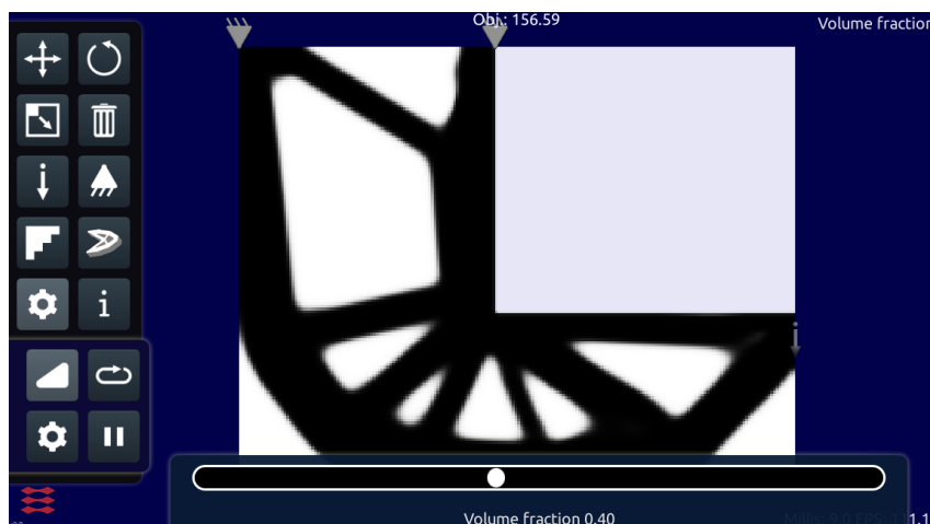
Figura 12 – Edição de volume da estrutura na aplicação TopOpt
