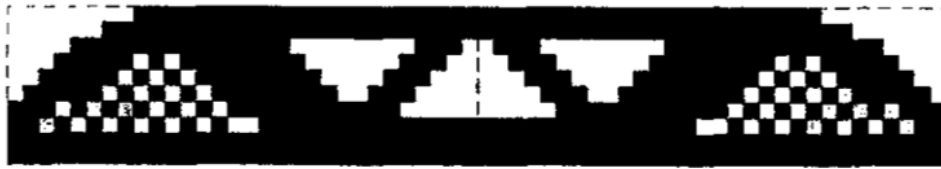
Figura 4 – Exemplo de geometria com instabilidade de tabuleiro
