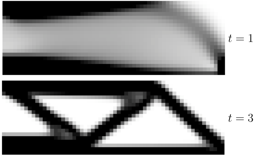
Figura 3 – Comparação entre uma otimização gerada sem e com penalização
