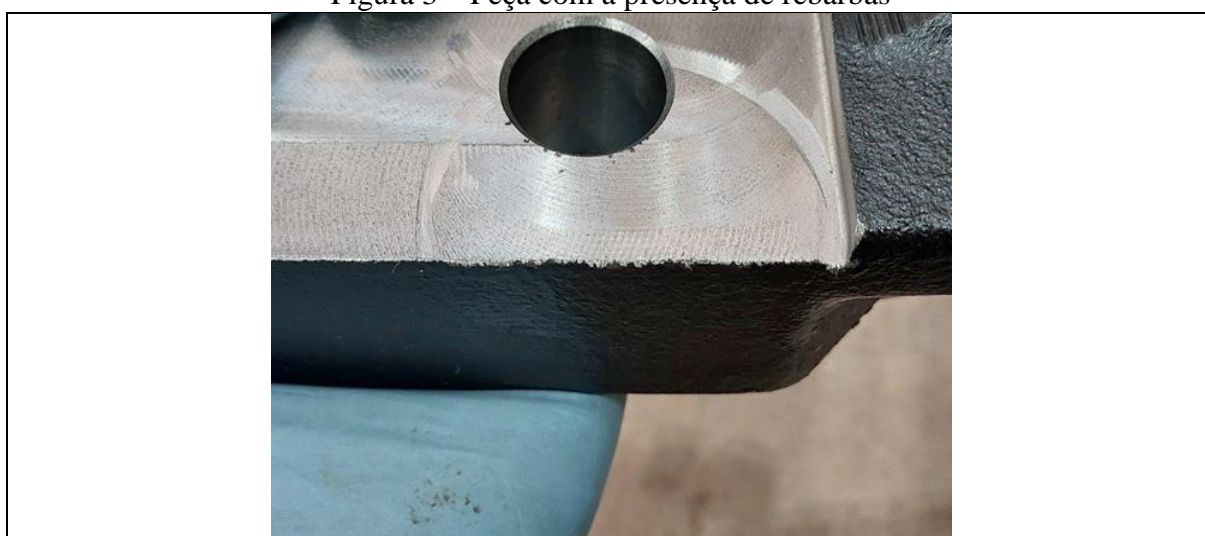
Figura 3 – Peça com a presença de rebarbas
