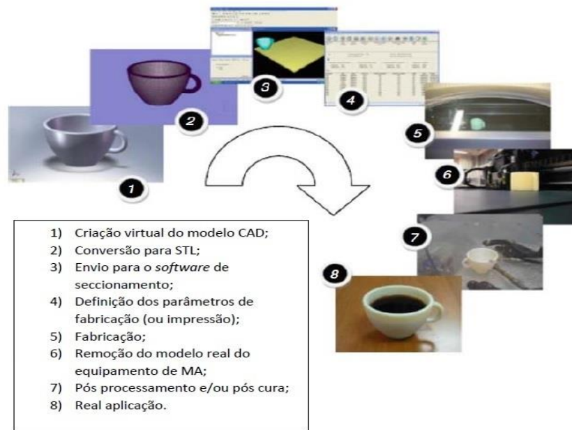
Figura 1: as 8 etapas para o processo da MA. Fonte: Additive Manufacturing Technologies.
