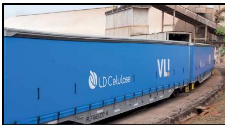
Figura 2 - Vagão ferroviário Sider FLF fabricado pela Randon em 2022
