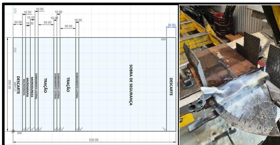
Figura 27 – Região da amostra de onde os corpos de prova foram retirados (à esquerda). À direita, aparece o procedimento de corte com serra fita refrigerada.
