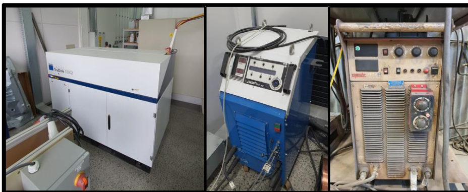
Figura 17 – Fontes utilizadas nos procedimentos: à esquerda está a fonte Laser, centralizada está a fonte IMC e à direita está a fonte SUMIG.
