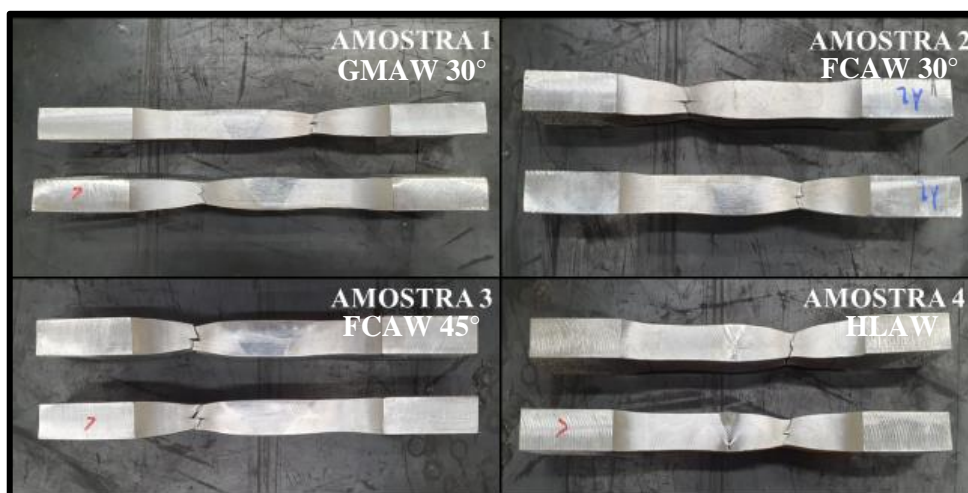
Figura 40 – Amostras rompidas após ensaio de tração.
