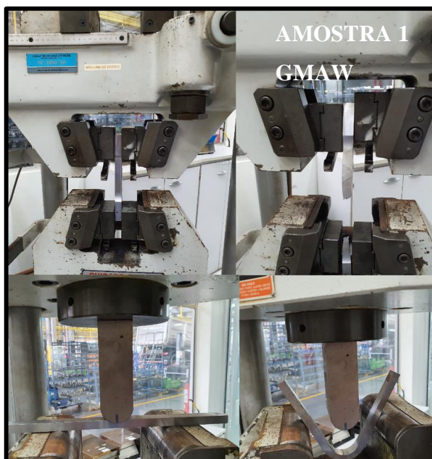
Figura 31 – Máquina de ensaios de tração e dobramento universal realizando ensaio da amostra 1 do processo GMAW.
