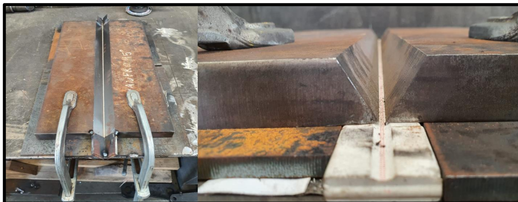
Figura 23 – Preparação das amostras 1, 2 e 3 na bancada para a soldagem.
