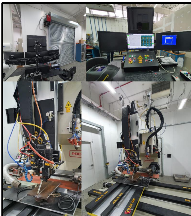
Figura 18 – Célula de soldagem híbrida do SENAI-SC
