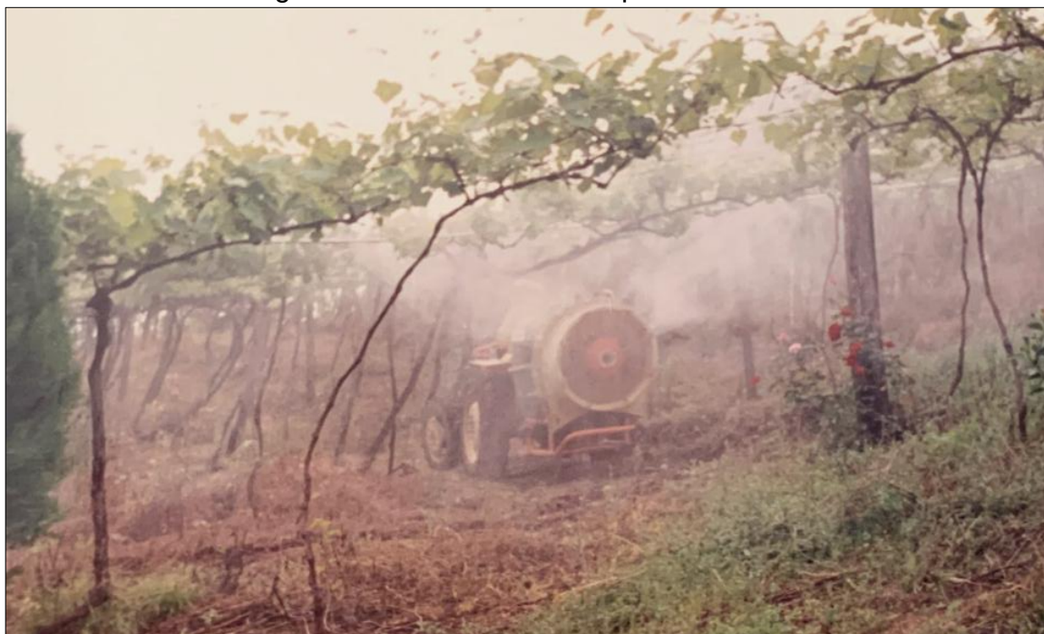
Figura 25 – Pulverizador acoplado ao trator
