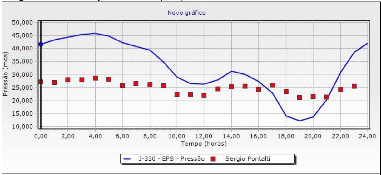
Figura 20 – Teste de ajuste de calibração apenas reduzindo o diâmetro na saída da válvula
