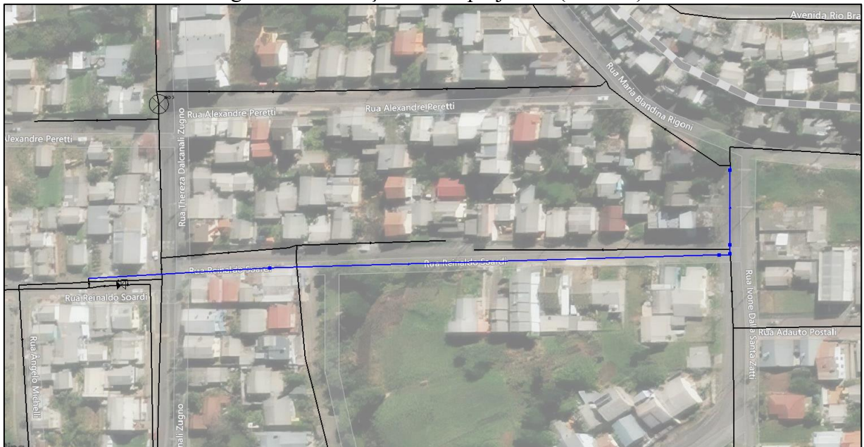
Figura 41 - Reforço de rede projetado (em azul)
