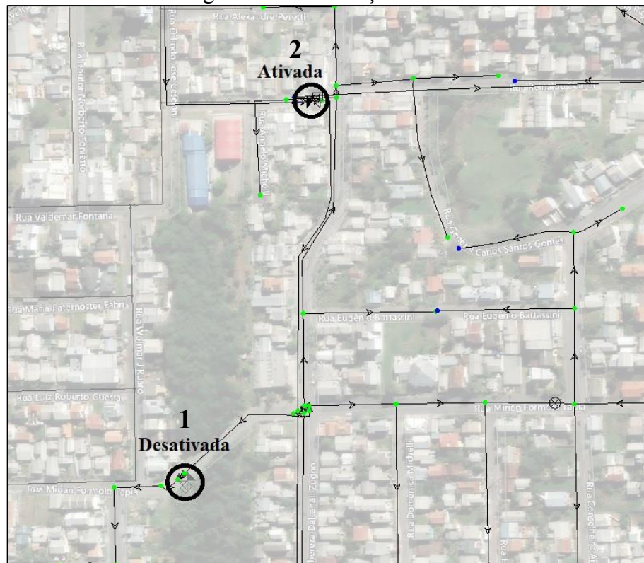
Figura 40 – Realocação da VRP
