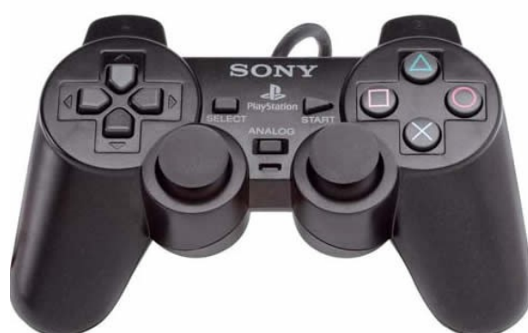
Ilustração 2: Joypad do PS2™ com direcionais analógicos e feedback háptico
