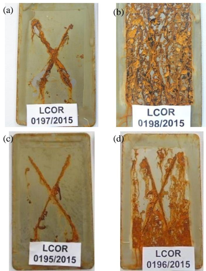
**Figura 43:** Revestimentos de poliuretano-ureia, após 48 h de teste em névoa salina. Para as razões de (NCO/OH/NH<sub>2</sub>): (a) 1,2/1/0 e (b) 1,2/0,3/0,7 preparados com óleo oxidado durante 24 h; (c) 1,2/1/0 e (d) 1,2/0,3/0,7 preparados com óleo oxidado durante 48 h.
