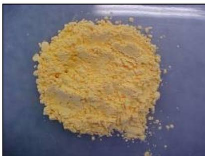
Figura 13 – Agente expansor azodicarbonamida utilizado na preparação de espumas de polietileno
