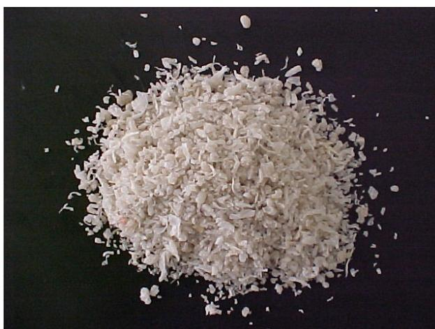
Figura 12 – Polietileno pós-consumo (p-PE) utilizado na preparação de espumas
