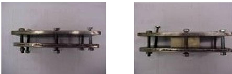
Figura 19 – Dispositivo utilizado para os ensaios de deformação permanente à compressão das espumas de polietileno (ASTM D 3575)
