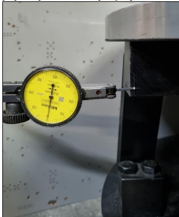
Figura 14 - Relógio apalpador posicionado na posição para coletar dados de rotação
