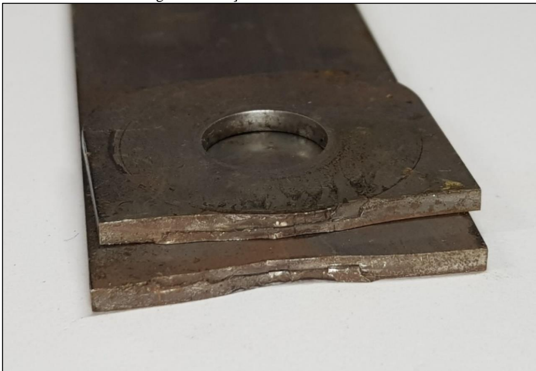
Figura 12 - Seção da falha em uma mola
