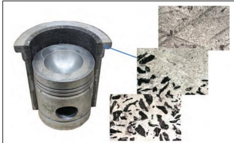
Figura 7: Camisa de cilindro fabricada em compósito de matriz metálica
