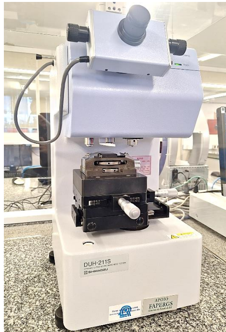
Figura 14 – Ultramicrodurômetro dinâmico usado nas medidas de módulo de elasticidade e dureza
