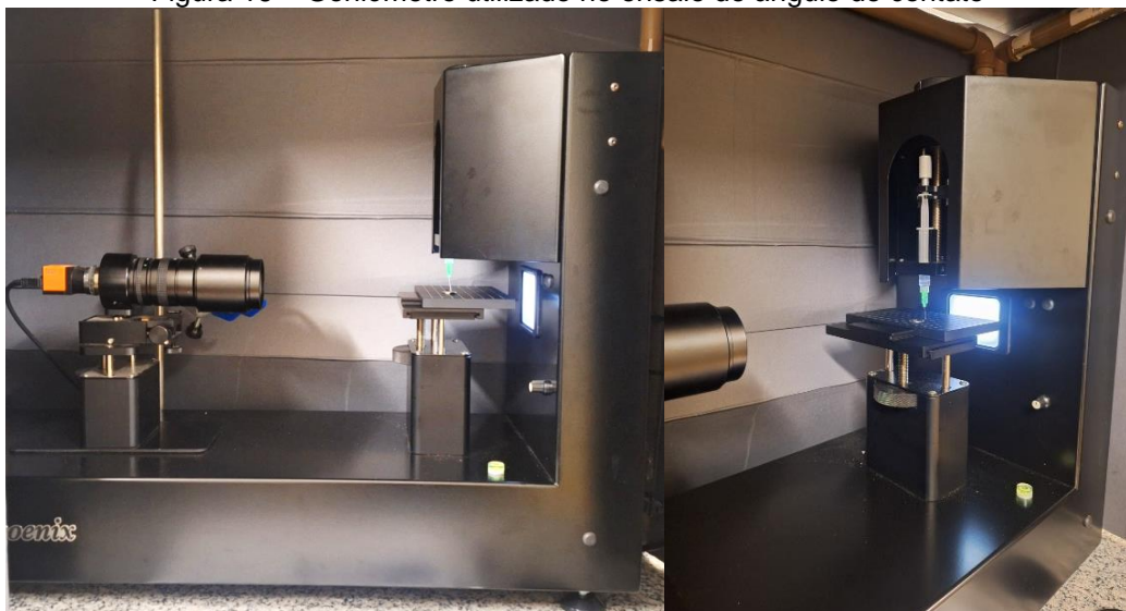
Figura 16 – Goniômetro utilizado no ensaio de ângulo de contato
