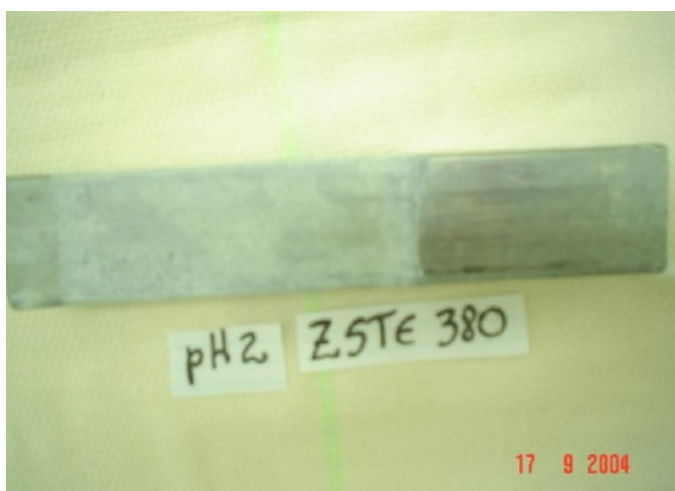
Figura 5.3: Fotografia do corpo de prova CP1, após as 503 horas de ensaio em pH2 (Fonte: Marcopolo, 2005).
