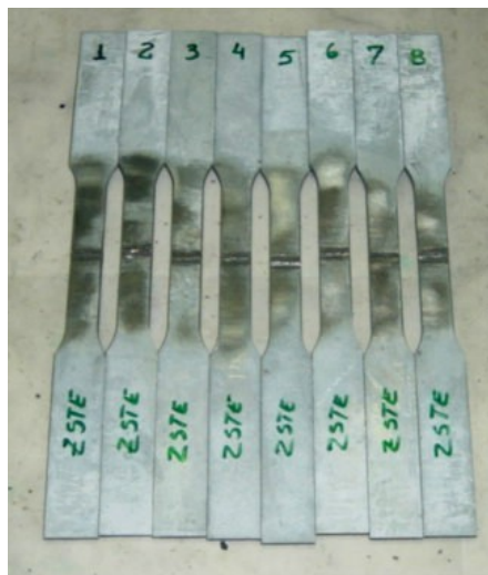
Figura 4.4: Corpos de prova para ensaio de tração, aço BLAR ZSTE 380. (Fonte: Arquivo Marcopolo, 2005 ).
