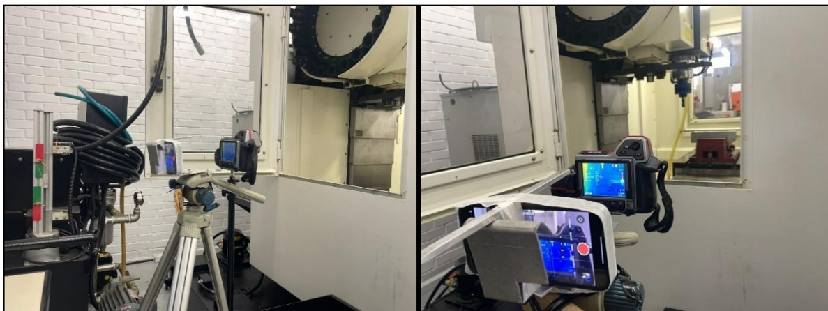
Figura 17 - Posicionamento da câmera termográfica
