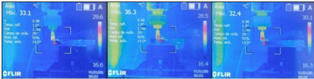
Figura 22 - Máxima temperatura de cada passe do segundo ensaio
