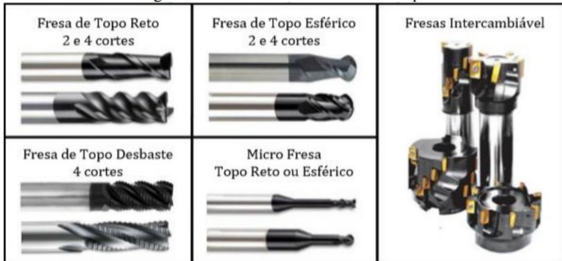
Figura 3 - Tipos de fresas de topo
