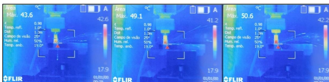
Figura 28 - Máxima temperatura de cada passe do quinto ensaio.
