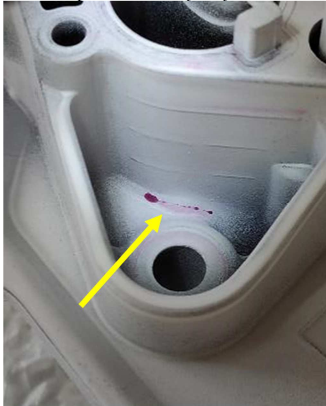
Figura 12 - Trincas evidenciadas pelo ensaio de líquido penetrante realizado na IPOS
