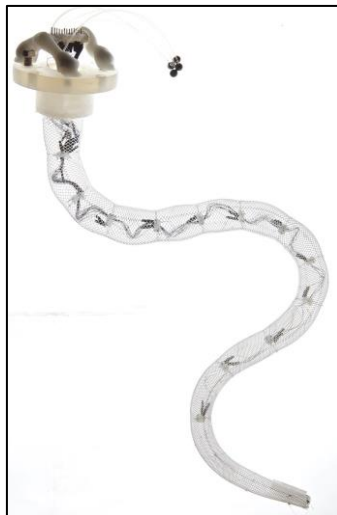
Figura 2 – Exemplo de um componente mecânico inspirado em um tentáculo de polvo, composto de fibras de PEAMM e molas de LEMF
