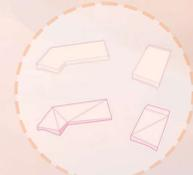
A COBERTURA FOI PENSADA DE FORMA A QUEBRAR COM OS ÂNGULOS RETOS DA EDIFICAÇÃO, PARA QUE A CONSTRUÇÃO REPRESENTASSE UMA FORMA DIFERENCIADA E NÃO UM PRISMA RÍGIDO COM ÂNGULOS QUE NÃO CONDIZEM COM A NATURALIDADE DA ARTE E DO SER HUMANO. DESSA FORMA, UTILIZAMOS AS MESMAS FORMAS INICIAIS DA EDIFICAÇÃO PARA A FORMAÇÃO DA DARDA DOS EDIFÍCIOS, CRIANDO-SE CHANFOS COMO EXEMPLIFICADO AO LADO, PARA QUE SE PUDESSE PROJETAR A FORMA FINAL DA COBERTURA.
