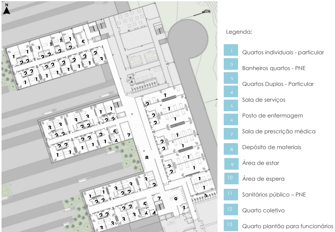
Figura 79 – Planta Baixa 3ª pavimento ampliada – Internações
