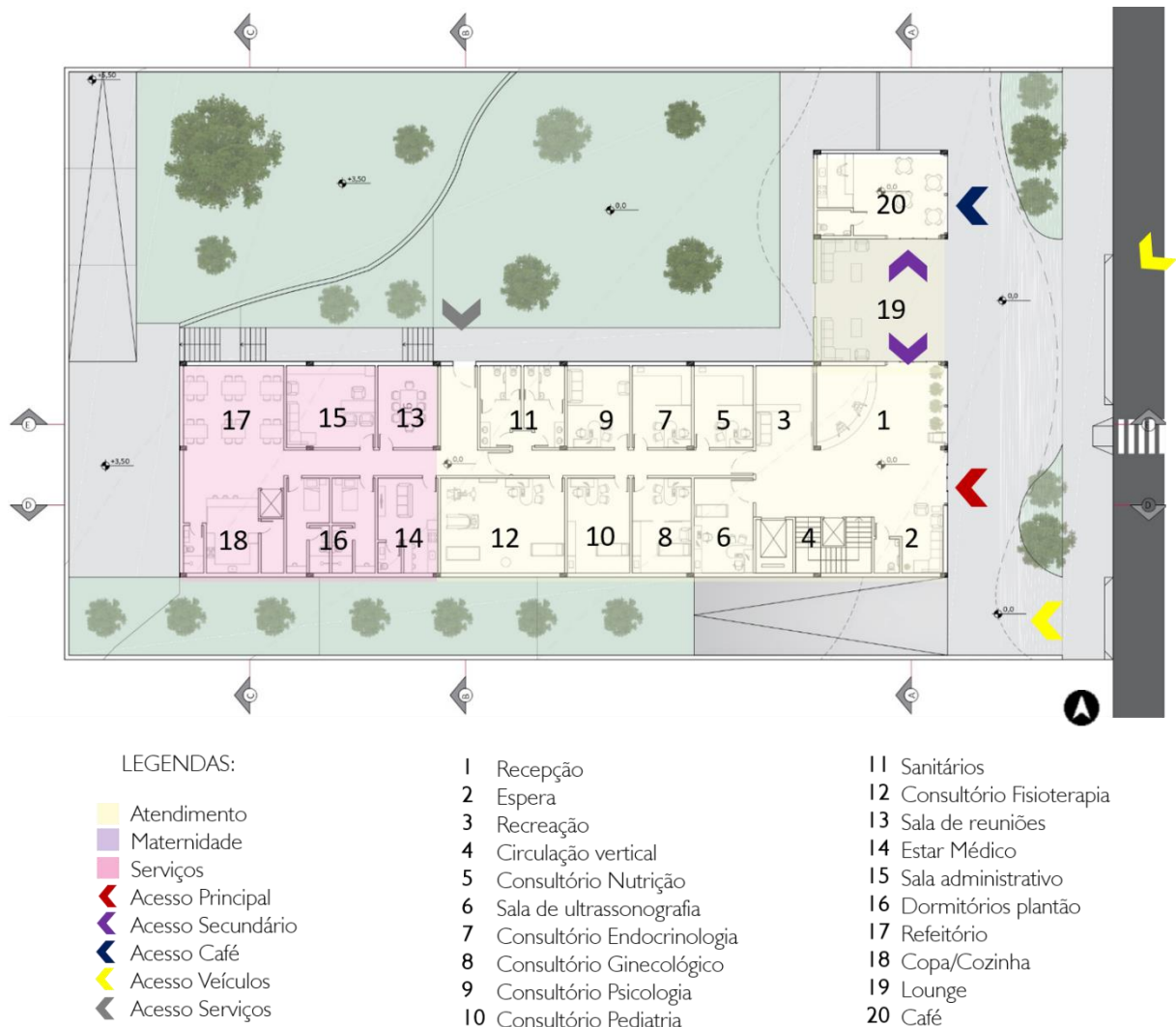
Figura 45 - Setorização Planta Baixa 1º pavimento
