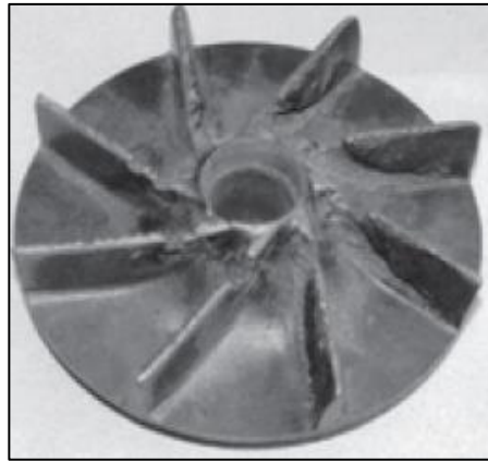
Figura 15: Rotor danificado por cavitação
