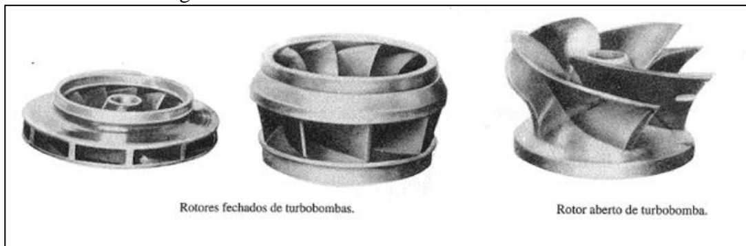
Figura 9: Rotor de Turbobomba aberto e fechado
