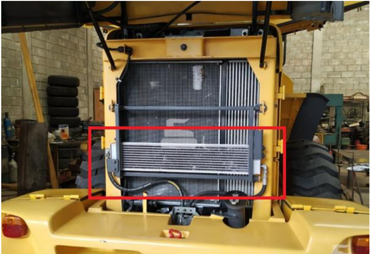
Figura 21 – Trocador de calor de fluido de transmissão
