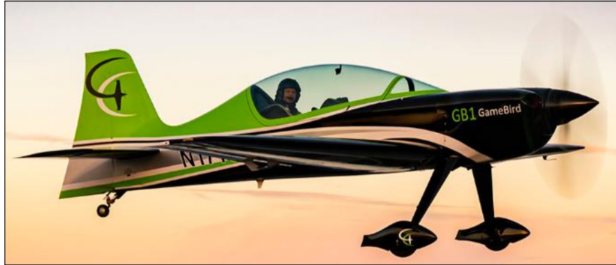
Figura 3 - Exemplo de trem de pouso convencional
