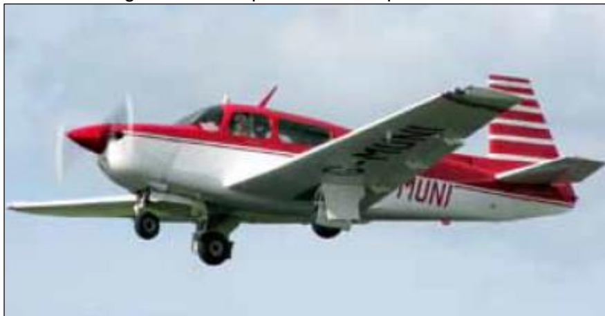
Figura 4 - Exemplo de trem de pouso triciclo
