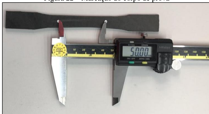
Figura 22 – Marcação do corpo de prova
