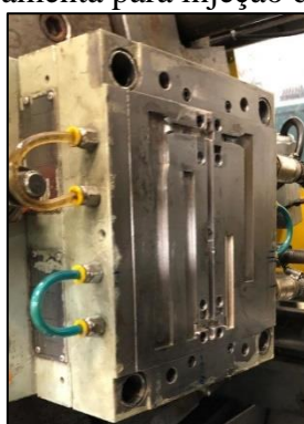
Figura 15 – Ferramenta para injeção de corpo de prova
