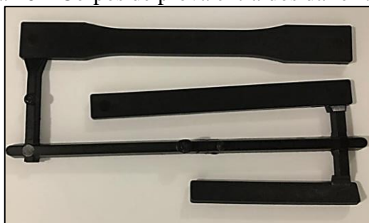
Figura 16 – Corpos de prova extraídos da ferramenta
