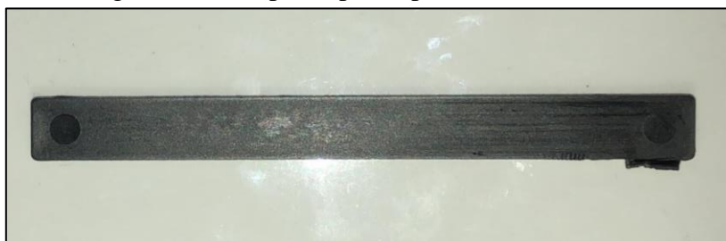
Figura 26 – Corpo de prova para ensaio de flexão
