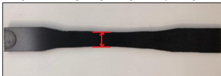
Figura 24 – Corpo de prova após redução do perfil
