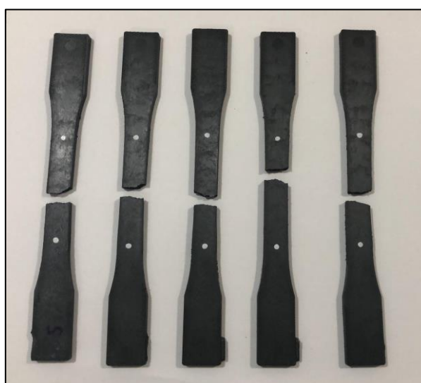
Anexo C – Relatório do ensaio de tração e imagem dos corpos de prova, PA6.6 + 25%FV + 3%GNP, fornecedor Y
