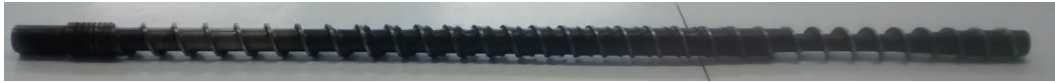
Figura 11. Perfil da rosca utilizada na extrusora mono rosca para o processamento da resina poliéster e do PETpc.
