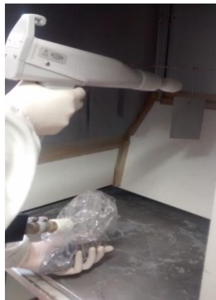
Figura 13. Fotografia da aplicação por pulverização eletrostática das tintas em pó base resina poliéster obtidas a partir dos processos 1 e 2 (Elaborada pelo autor, 2015).
