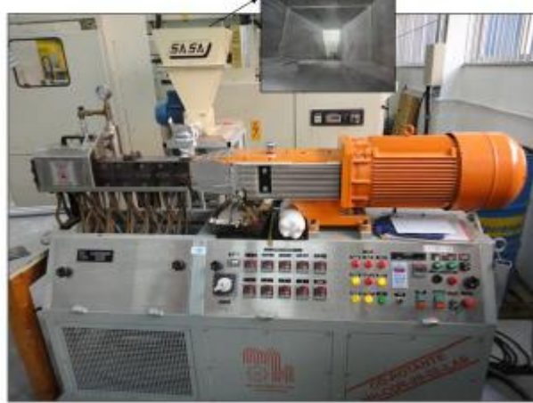
Figura 8. Fotografia da extrusora dupla rosca (Elaborada pelo autor, 2016).
