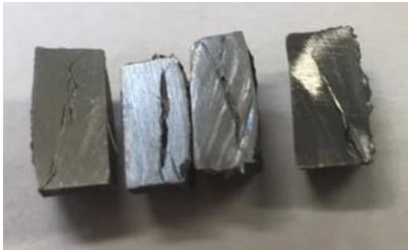
Figura 35 – Defeitos (trincas) presentes nas amostras sinterizadas
