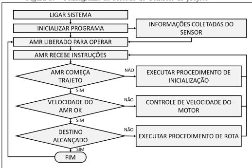
Figura 17 – Fluxograma do Método de Controle do projeto
