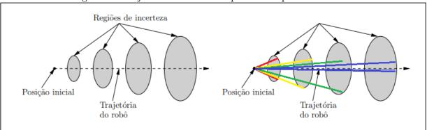
Figura 9 – Trajeto de um veículo representado pela Odometria
