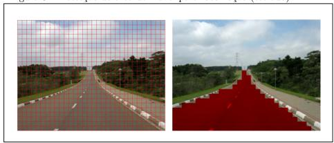
Figura 8 – Detecção de área utilizável para locomoção (estrada)
