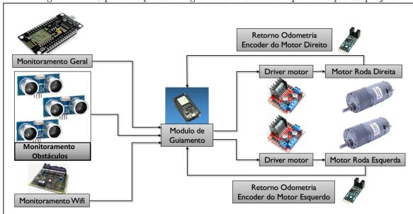
Figura 14 – Representação do Diagrama de blocos da implementação do projeto
