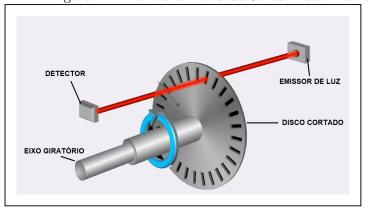
Figura 21 – Funcionamento do Sensor Foto-Elétrico
