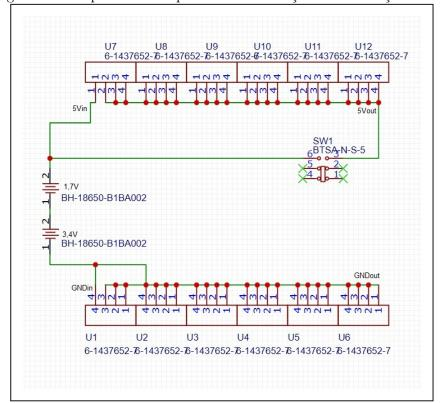
Figura 29 – Esquemático da placa de Alimentação e Distribuição 21x5V
