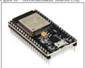
Figura 16 – Microcontrolador NodeMCU-32
