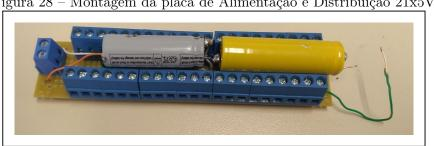
Figura 28 – Montagem da placa de Alimentação e Distribuição 21x5V
