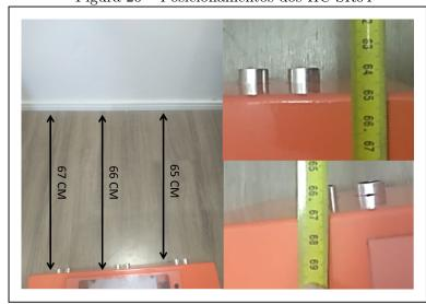
Figura 26 – Posicionamentos dos HC-SR04
