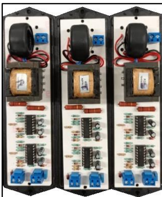
Figura 25: Condicionadores de sinais de corrente e tensão para monitoramento do sistema trifásico.
