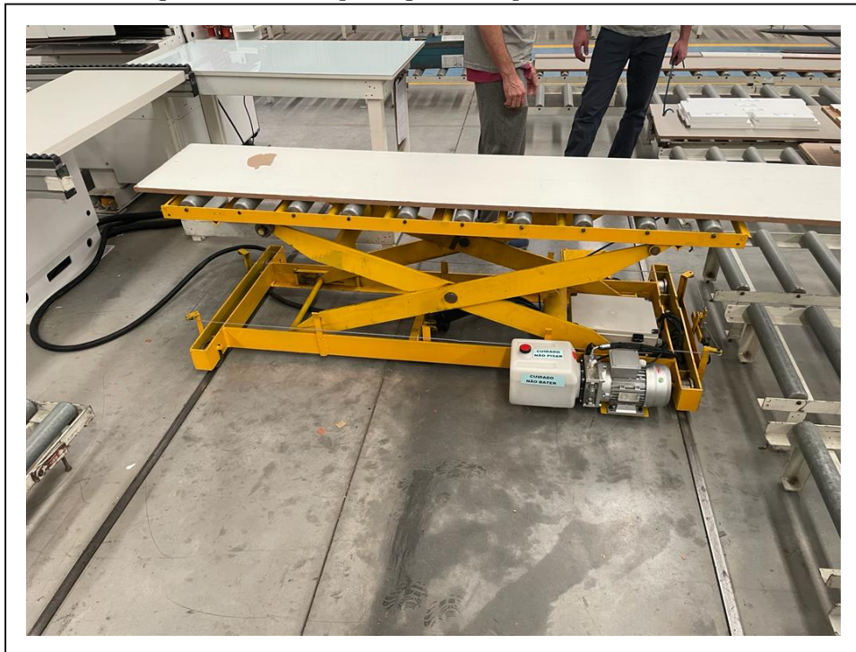
Figura 48 – Mesa pantográfica depois da reforma
