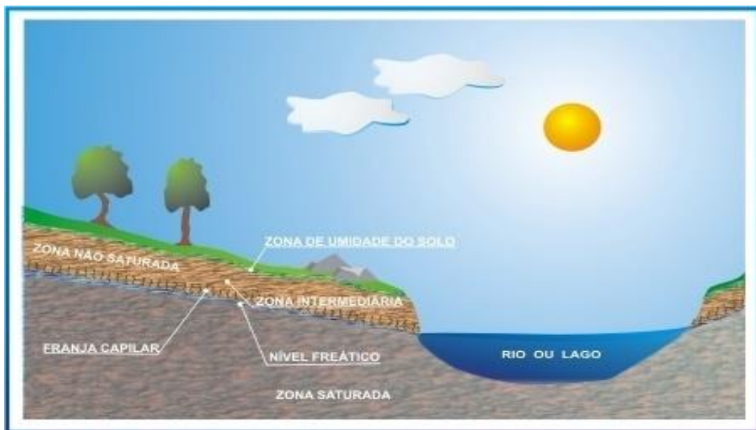
Figura 1 – Caracterização esquemática das zonas não saturadas e saturadas no subsolo
