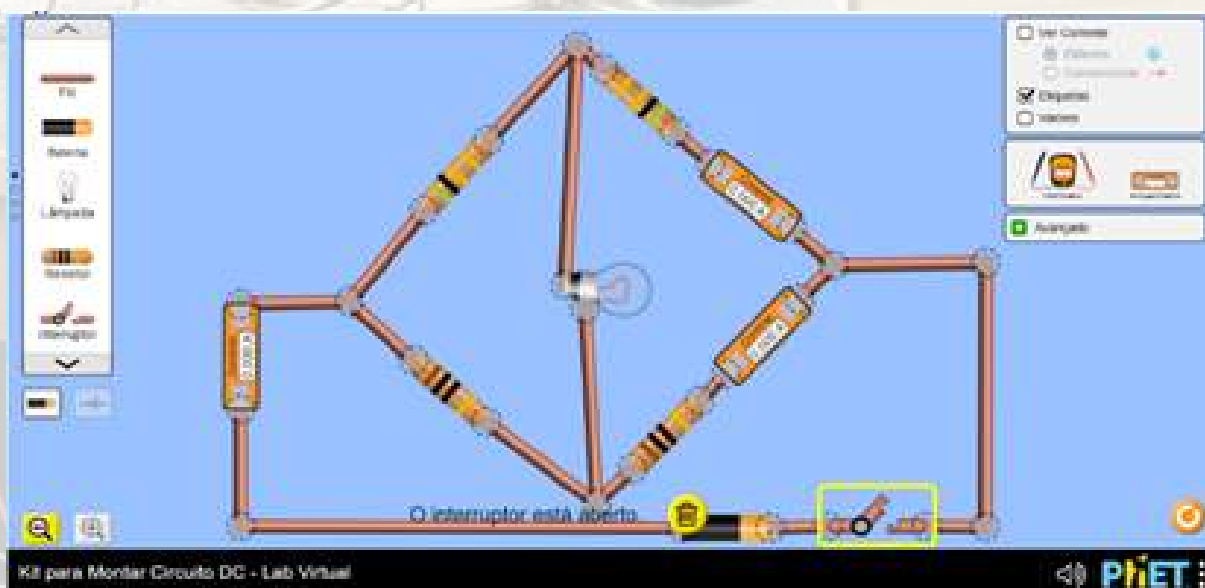
Ponte de Wheatstone. Fonte: FRAZÃO, 2021
