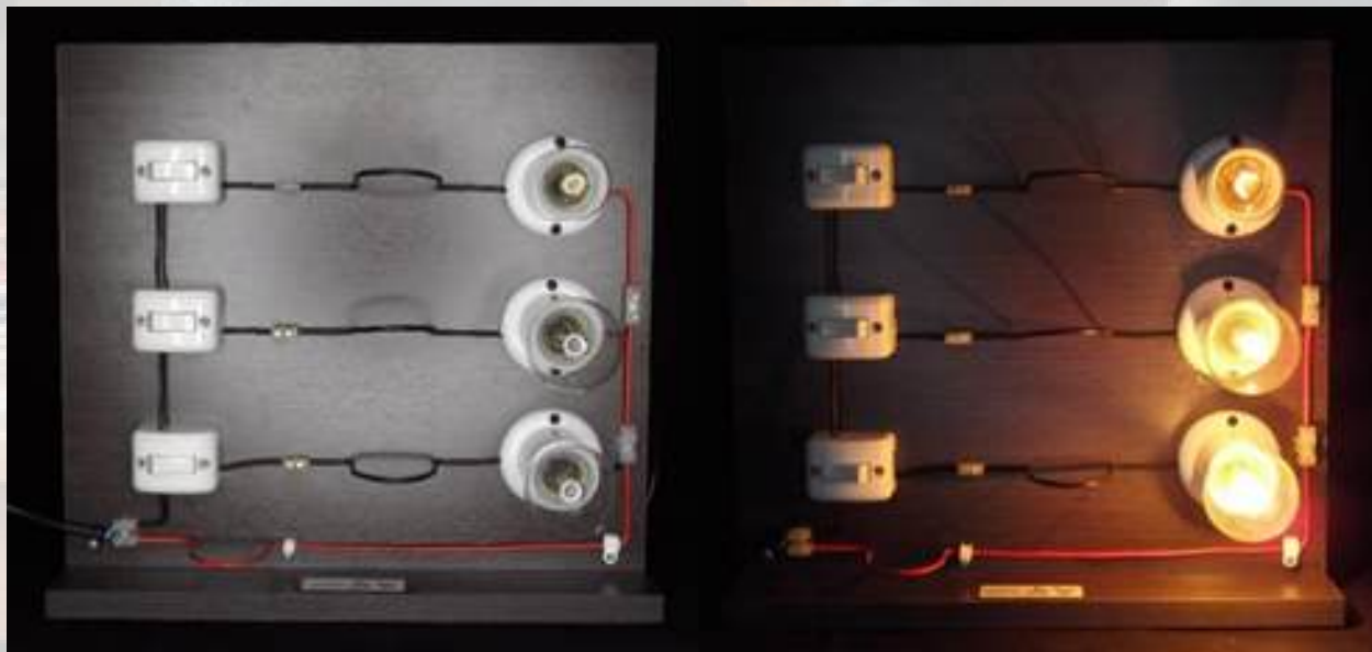
Face do painel onde três lâmpadas (apagadas na imagem da esquerda e acesas na da direita) estão conectadas em paralelo.
