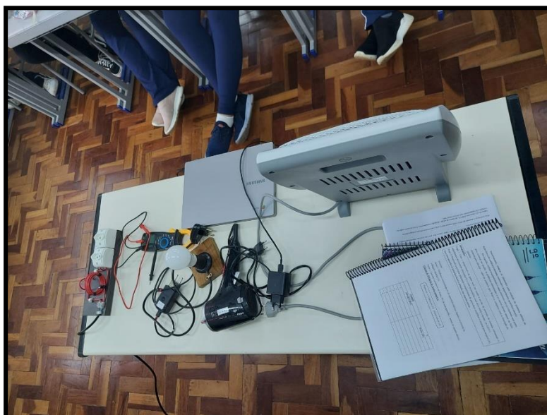
Figura 11- Materiais usados para experimentação com a tomada para a medição de potência de aparelhos do cotidiano
