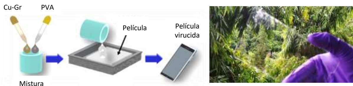
Figura 9 - Película de tela de celular transparente de PVA contendo cobre e grafeno
