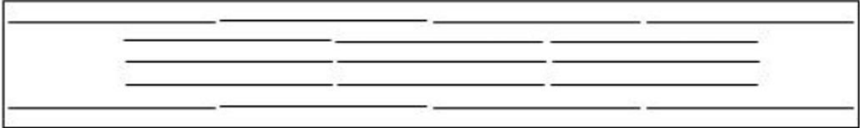
Figura 7 - Arranjo de 17 fibras no molde
