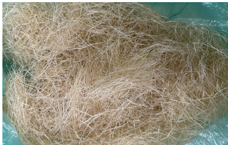
Figura 13 - Fibras de sisal cortadas em 20 mm
