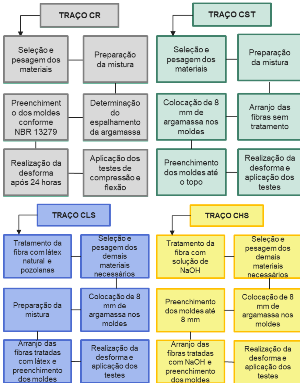
Figura 16 - Procedimento de mistura dos materiais
