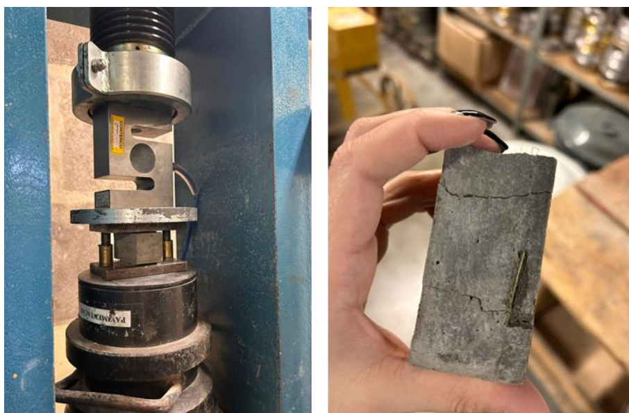
Figura 21 - Ensaio de resistência a compressão
