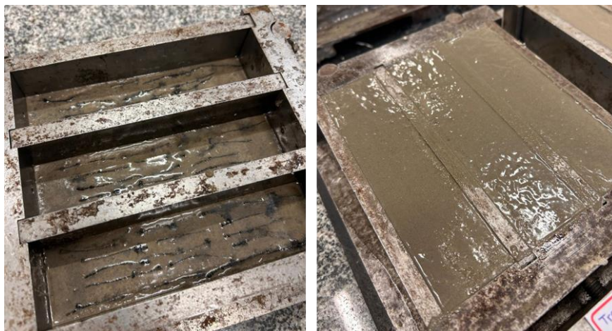
Figura 18 - Arranjo das fibras nos moldes
