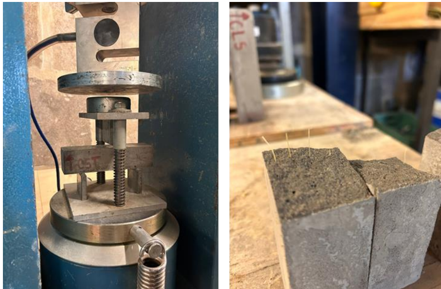
Figura 20 - Ensaio resistência a tração na flexão
