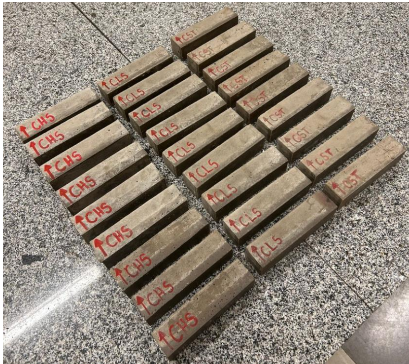
Figura 19 - Corpos de prova após serem desmoldados
