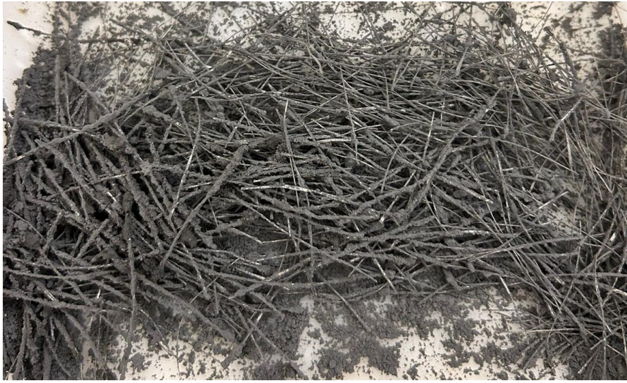
Figura 15 - Fibras de sisal tratadas com látex e pozolanas
