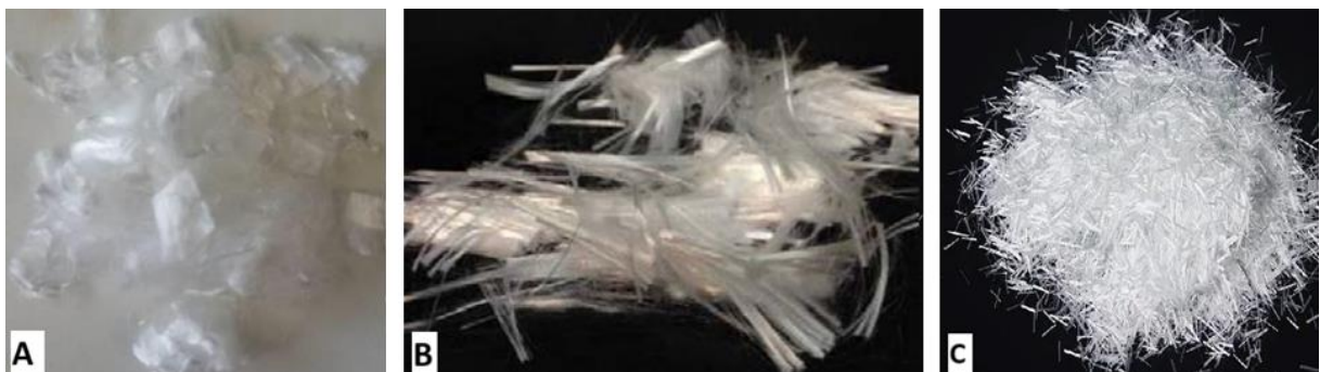
Figura 1 - Fibra de polipropileno (a), fibra de poliéster (b) e fibra de vidro (c)
