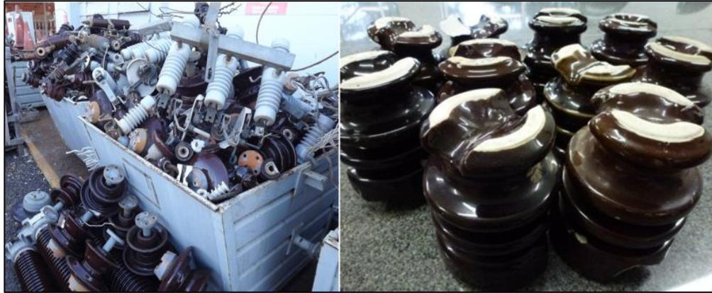
**Figura 5.** Resíduos de isoladores elétricos cerâmicos nas estações avançadas.
