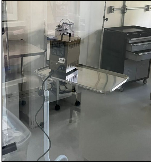
Figura 11: Bomba de ozônio em funcionamento para limpeza das salas do centro cirúrgico da Synthese Veterinária Especializada
