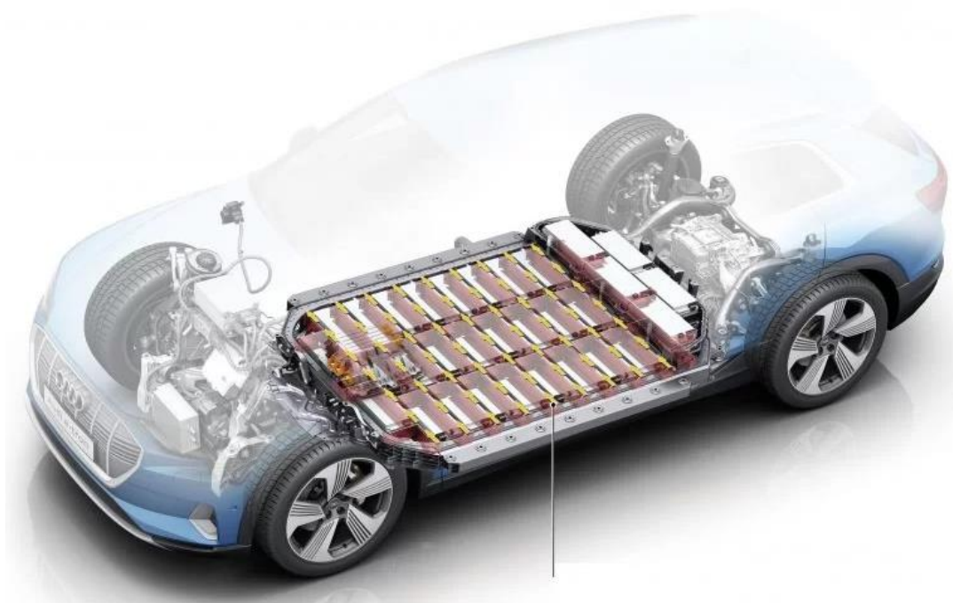
Figura 1 - Bateria de carro elétrico centralizada embaixo do assoalho do veículo elétrico.
