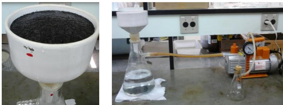
**Figura 18.** Representação do processo de filtração à vácuo do *char* impregnado de  $H_3PO_4$
