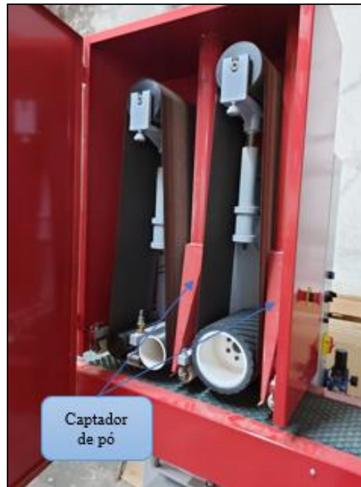
Figura 24 – Captadores de pó.
