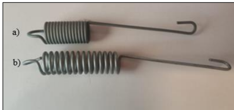
Figura 22 – Mola de extensão (a) condição original e (b) com deformação permanente
