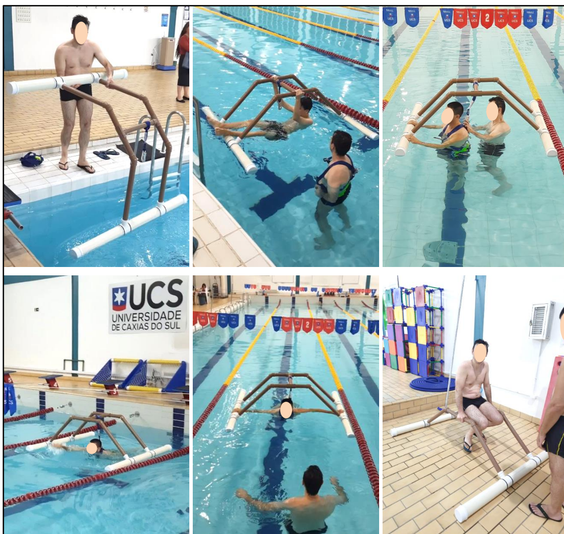
Figura 26 - Testes práticos com o protótipo construído (a) colocando e retirando da piscina, (b) verificando a estabilidade/flutuabilidade, (c) ligando o cinturão de segurança à estrutura, (d) praticando o nado, (e) demonstrando espaço na largura e (f) a resistência mecânica.
