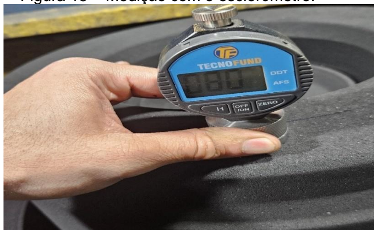
Figura 15 – Medição com o esclerômetro.
