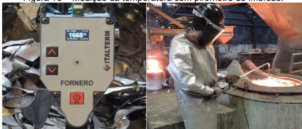
Figura 16 – Medição da temperatura com pirômetro de imersão.
