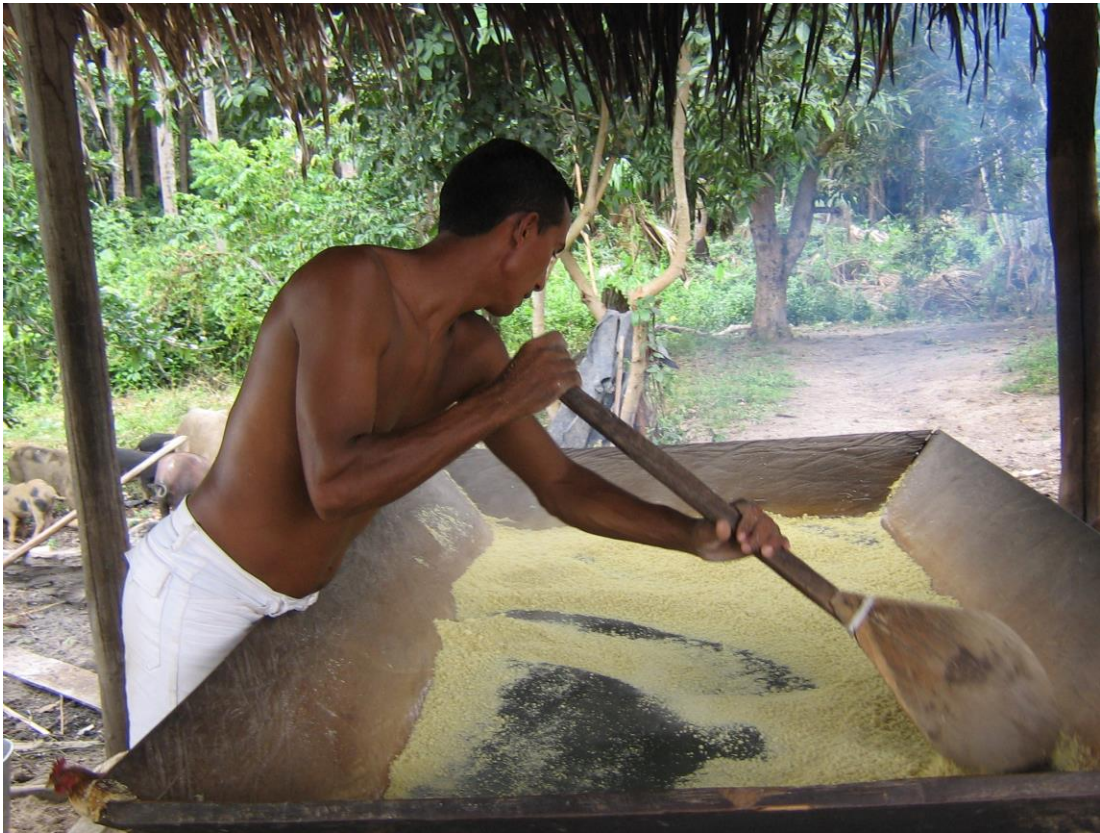
Figura 10: Processo de torrefação da farinha na Comunidade de Banguelas, realizado em um forno artesanal
