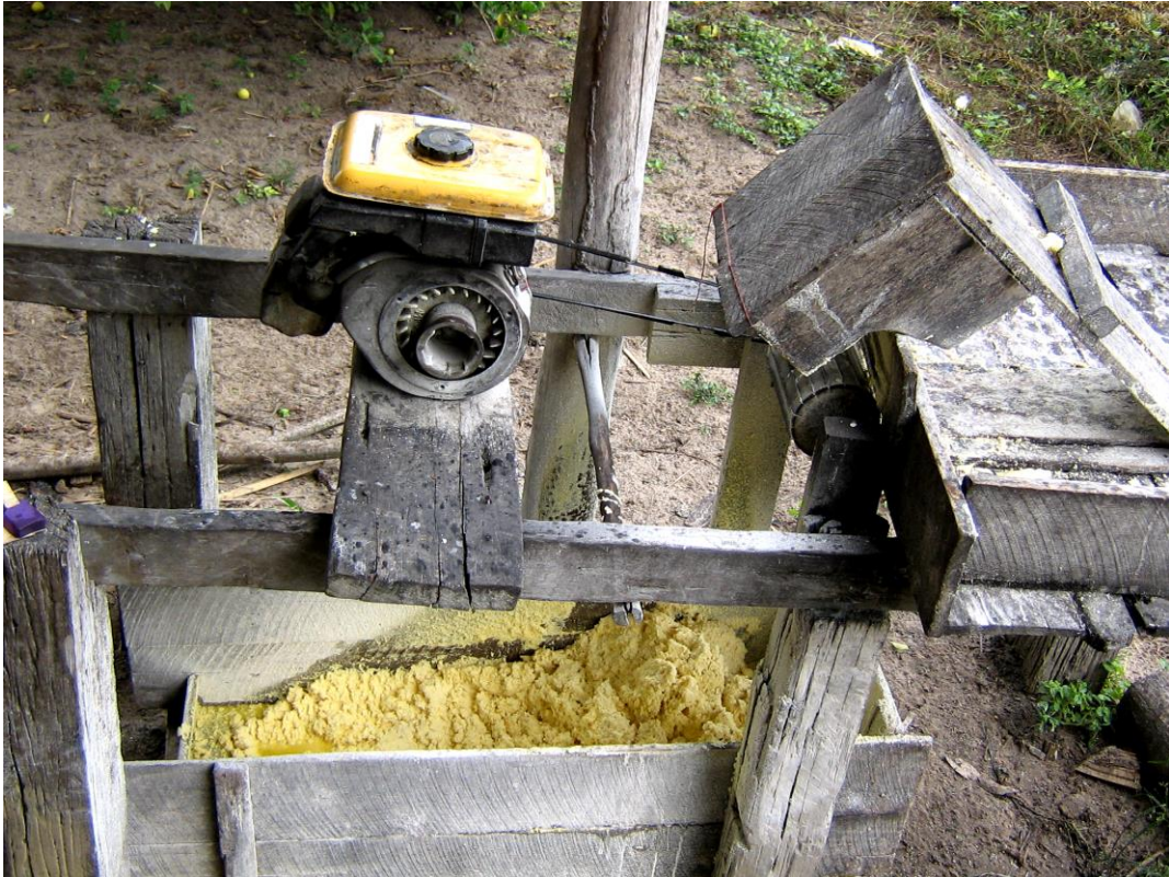
Figura 9: Mandioca sevada, obtida através de um processo mecanizado tradicional, utilizando equipamentos simples e rústicos na Comunidade de Banguelas
