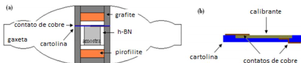
Figura 10 – Em (a), esquema da montagem para calibração da pressão e em (b), esquema ampliado do circuito elétrico. Adaptado da referência [86]
