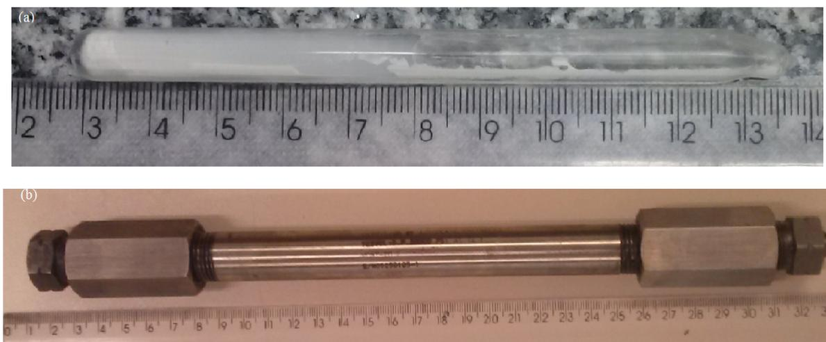
Figura 17 – (a) Ampola de vidro contendo  $\alpha\text{-ZrW}_2^{17}\text{O}_8$  e a água enriquecida com oxigênio 17 e (b) vaso de pressão utilizado para a preparação do  $\alpha\text{-ZrW}_2^{17}\text{O}_8$ .
