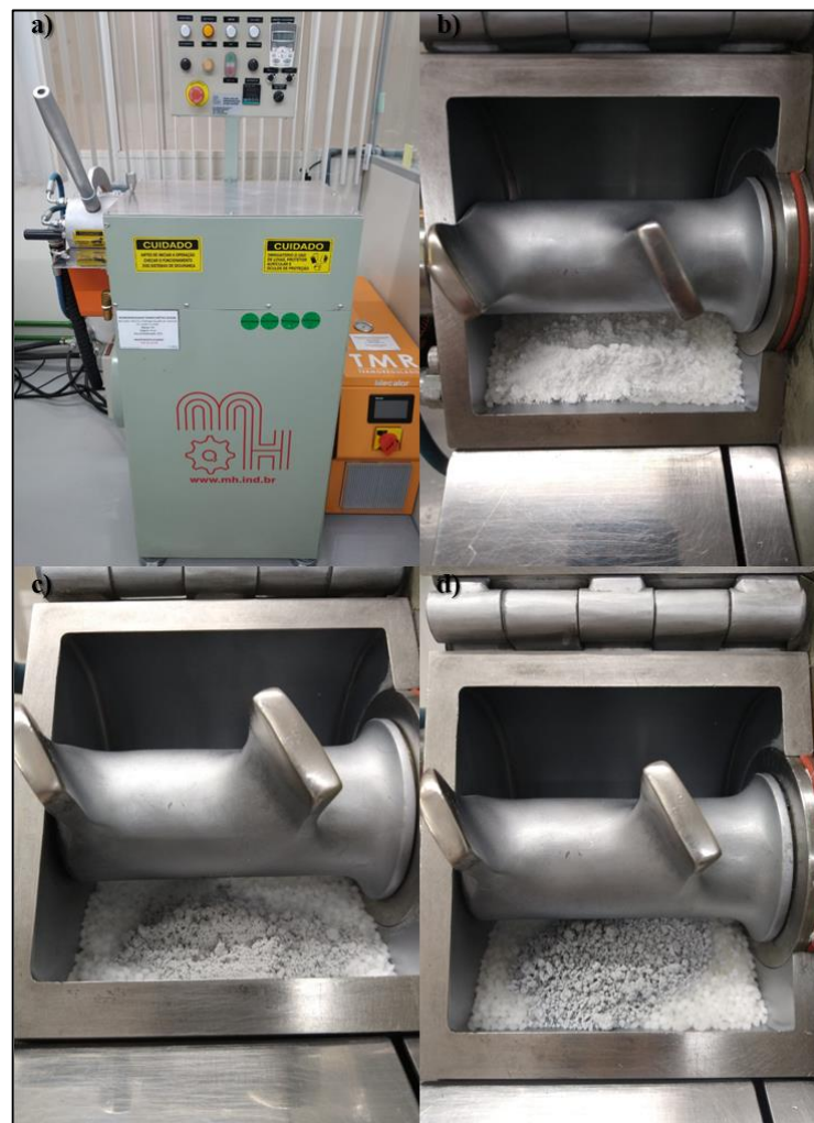
Figura 18 – Obtenção dos nanocompósitos por mistura no estado fundido. a) homogeneizador termocinético, b), c) e d) Câmara de mistura com PA6 e 5% de masterbatch para produção dos nanocompósitos.
