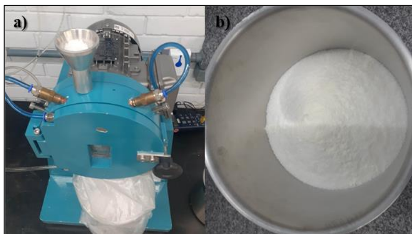
Figura 14 – a) Micronização da PA6, b) PA6 micronizada.
