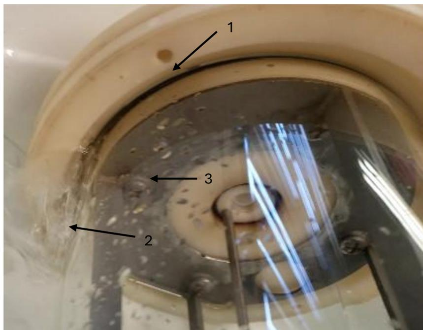
Figura 12. Vedação interna por *O-ring* do biorreator. 1. Anel tipo *O-ring* para fechamento do biorreator (antigo sistema). 2. Bolhas de ar com biorreator submerso e submetido a aeração. 3. Sistema antigo de fechamento do biorreator.
