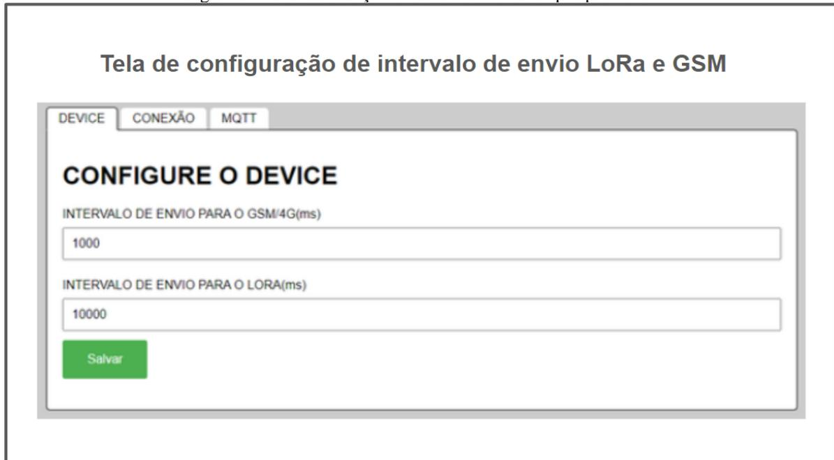
A interface de configuração apresenta um cabeçalho com as abas "DEVICE", "CONEXÃO" e "MQTT". O título principal é "Tela de configuração de intervalo de envio LoRa e GSM". Abaixo, há uma seção "CONFIGURE O DEVICE" com dois campos de entrada: "INTERVALO DE ENVIO PARA O GSM/4G(ms)" com o valor "1000" e "INTERVALO DE ENVIO PARA O LORA(ms)" com o valor "10000". Um botão verde "Salvar" está localizado na base da seção.
