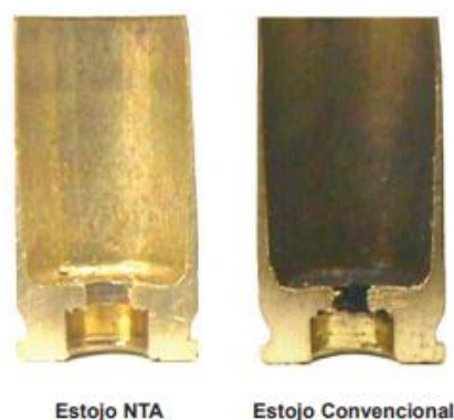
Figura 8 - Comparação entre estojos deflagrados utilizando pólvora sem fumaça e comum respectivamente.
