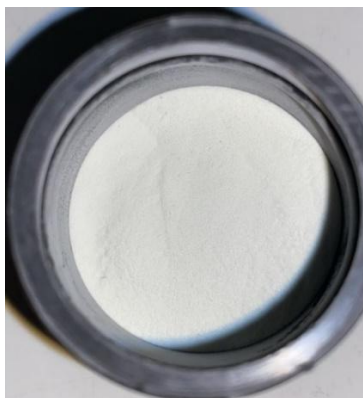
Figura 12 - Aluminato de estrôncio dopado com európio e disprósio utilizado nos testes.
