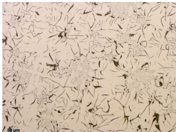
Figura 16. Imagem de microestrutura óptica do corpo de prova da AMOSTRA 9 (frigideira de ferro fundido)
