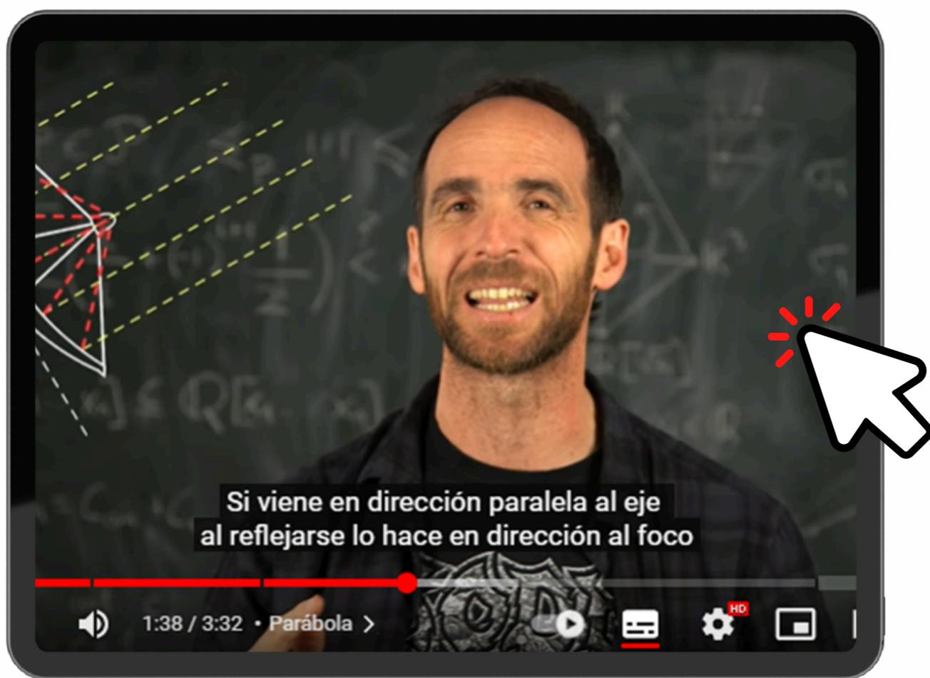
A resposta para o questionamento inicial é que a parábola é uma curva que tem a propriedade de refletir todos os raios paralelos ao seu eixo em direção ao seu foco. Isso significa que uma antena parabólica pode concentrar todas as ondas de rádio que chegam a ela em um único ponto, o que é muito útil para captar sinais fracos.
