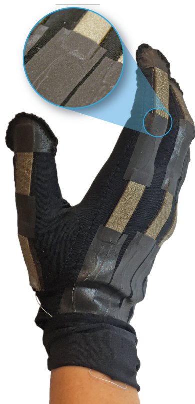
Figura 8 – Sensor utilizado para ler os movimentos da mão.
