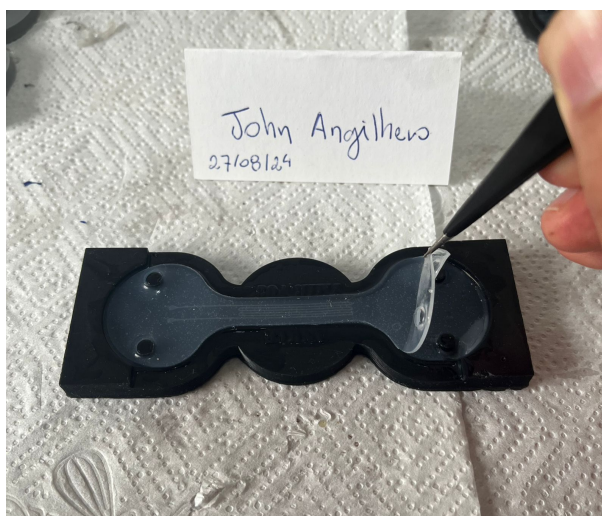
Figura 28 – União da parte inferior com a superior do sensor.
