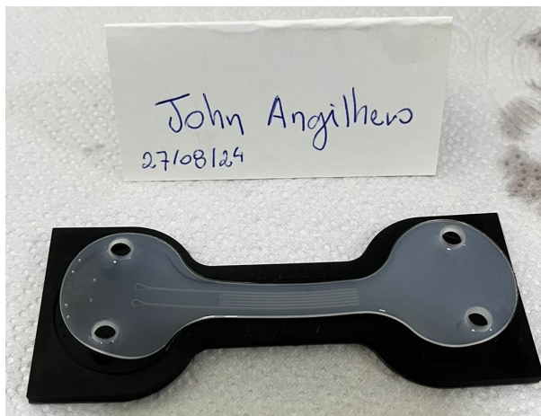
Figura 27 – Desmolde parte superior do sensor.
