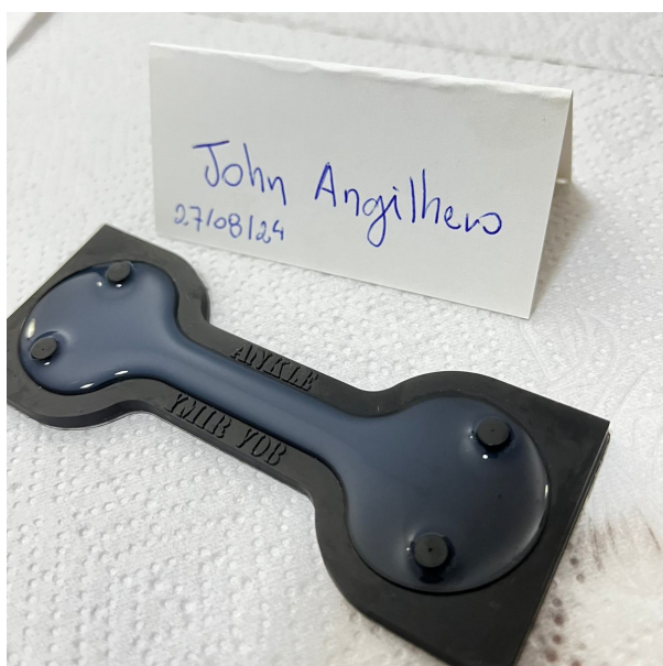
Figura 26 – Molde superior com resina.
