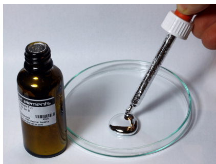
Figura 10 – Liga metálica líquida.
