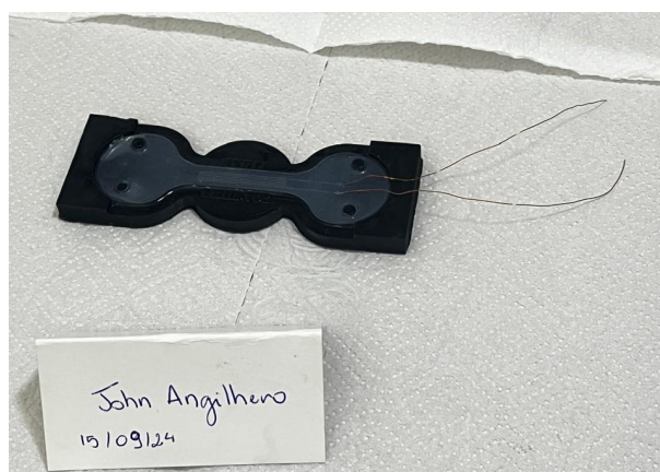
Figura 30 – Aplicação dos condutores do sensor.
