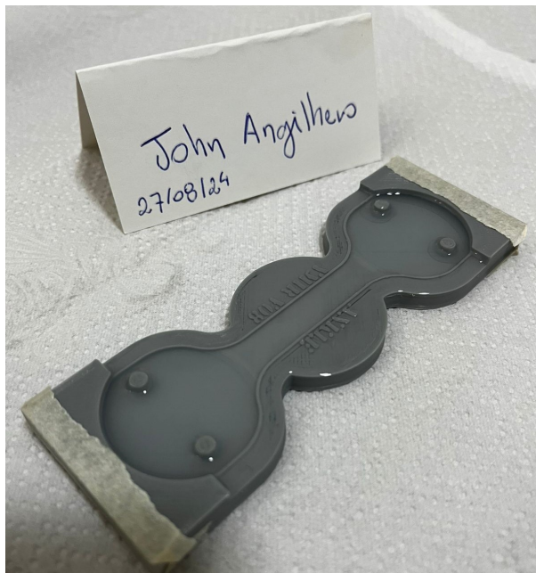
Figura 25 – Molde inferior com resina.
