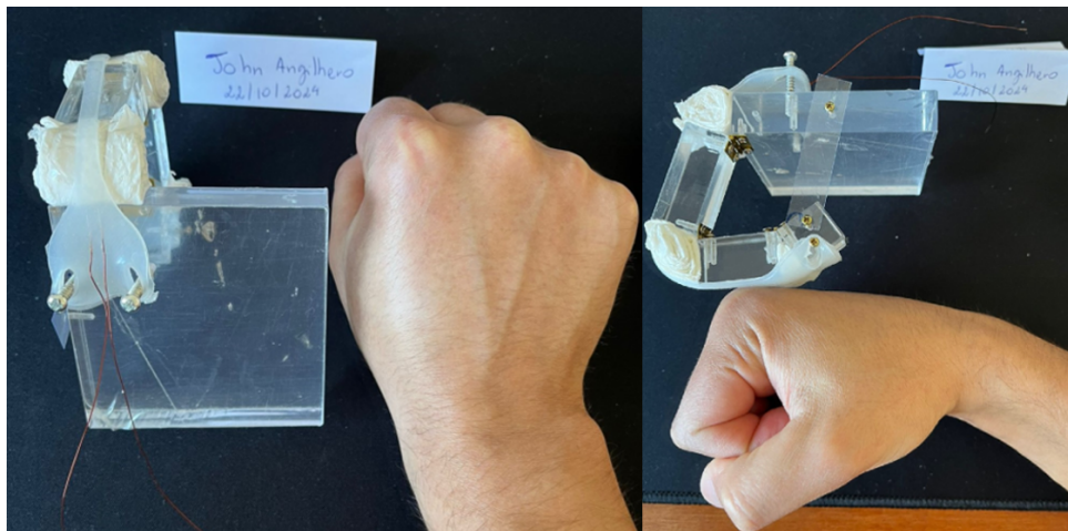
Figura 46 – Sensor acoplado ao dedo na posição de mão fechada em punho.
