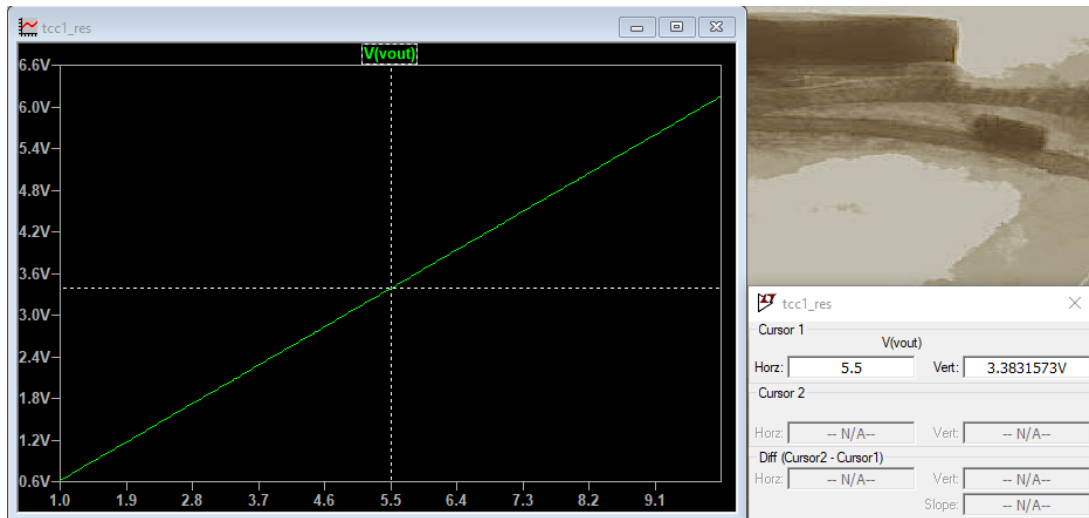
Figura 21 – Tensão x Resistência, amplificado.
